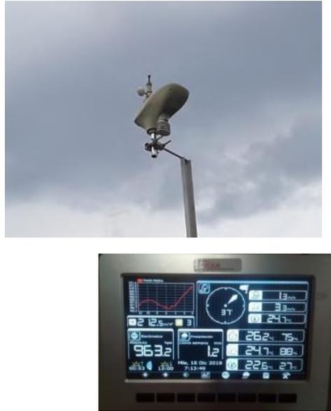
Figura 2. Ubicación de la estación meteorológica marca RIKA modelo RK900-05
